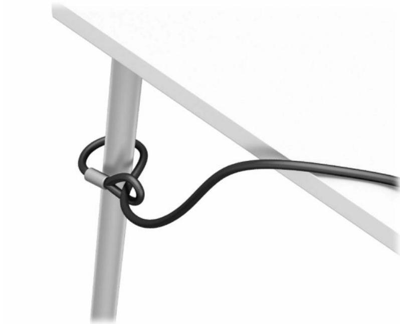
3. Schieben Sie das Sicherheitskabel durch die Halterung des Sicherheitskabels.
