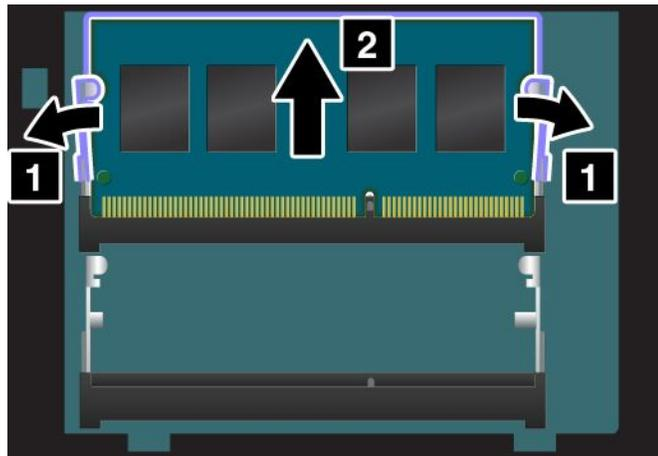
5. Setzen Sie das neue Speichermodul so ein, dass das eingekerbte Ende zur Kontaktseite des Speichersteckplatzes zeigt. Setzen Sie dann das Speichermodul **1** in einem Winkel von etwa 20 Grad in den Steckplatz ein. Klappen Sie das Speichermodul nach unten, bis es hörbar einrastet **2**. Stellen Sie sicher, dass das Speichermodul fest im Steckplatz installiert ist und nur schwer bewegt werden kann.
