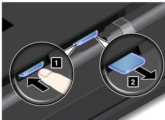
4. Setzen Sie die neue Micro-SIM-Karte fest in diese Öffnung, bis sie hörbar einrastet.
