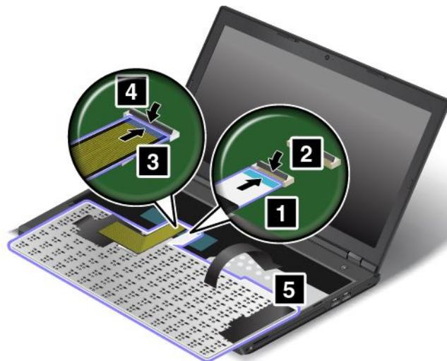
2. Setzen Sie die Tastatur wie abgebildet in die Tastaturblende ein. Stellen Sie sicher, dass sich die hintere Kante der Tastatur (die zur Computeranzeige weisende Kante) unter dem Rahmen der Tastaturblende befindet.
