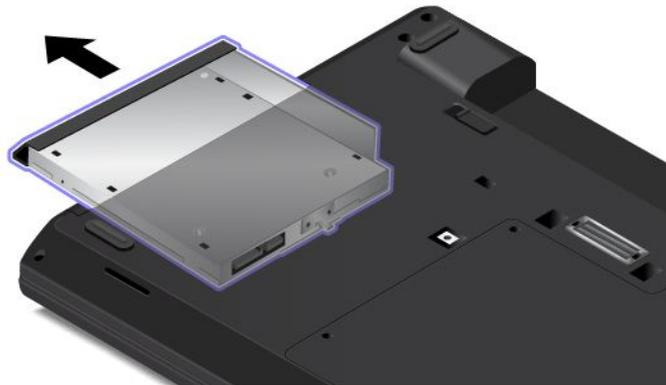
5. Setzen Sie das neue optische Laufwerk in die Position.
