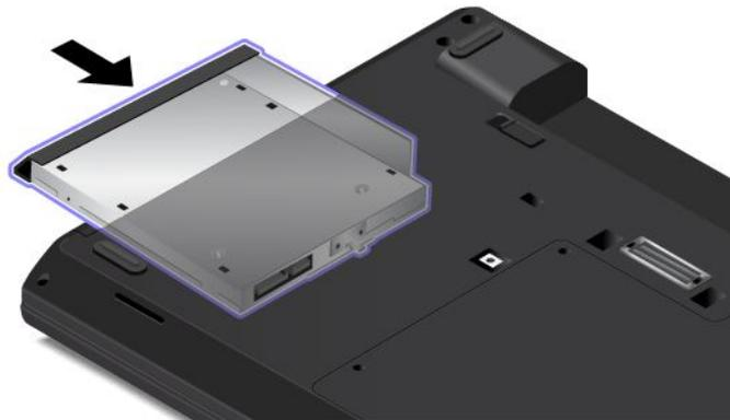
6. Bringen Sie die Schraube an, um das neue optische Laufwerk zu befestigen.
