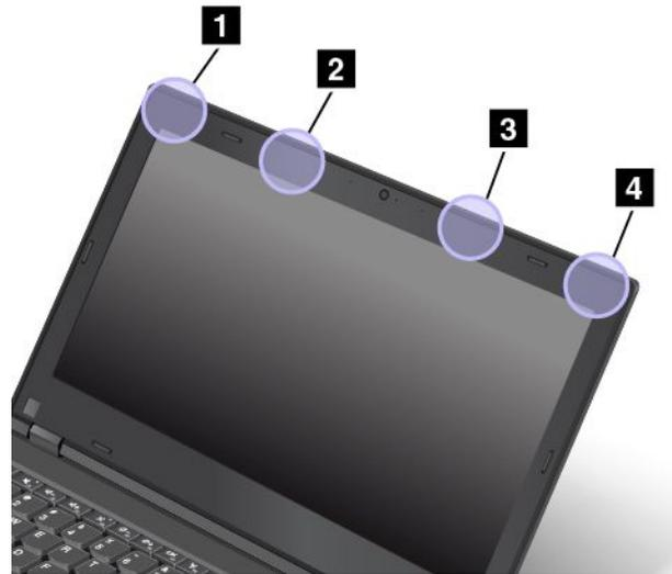
**1** Antenne für drahtlose LAN-Verbindungen (Hauptantenne)
