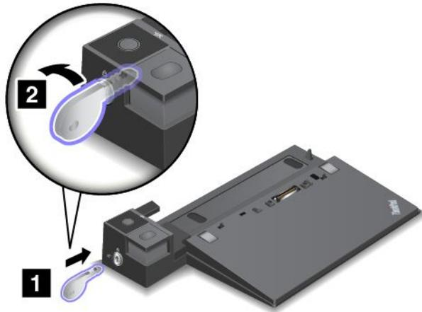
3. Richten Sie die obere linke Ecke des Computers mit der Positionsmarkierung der Andockstation aus. Setzen Sie Ihren Computer vertikal in die Andockstation ein, bis er hörbar einrastet **1**. Der Computer ist nun an die Andockstation angeschlossen. Drehen Sie dann den Sperrschlüssel für das System in die gesperrte Position (horizontal) **2**.
