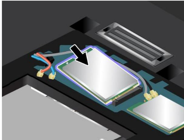
8. Klappen Sie die neue drahtlose WAN-Karte nach unten **1** und bringen Sie dann die Schraube an, um die Karte zu sichern **2**.
