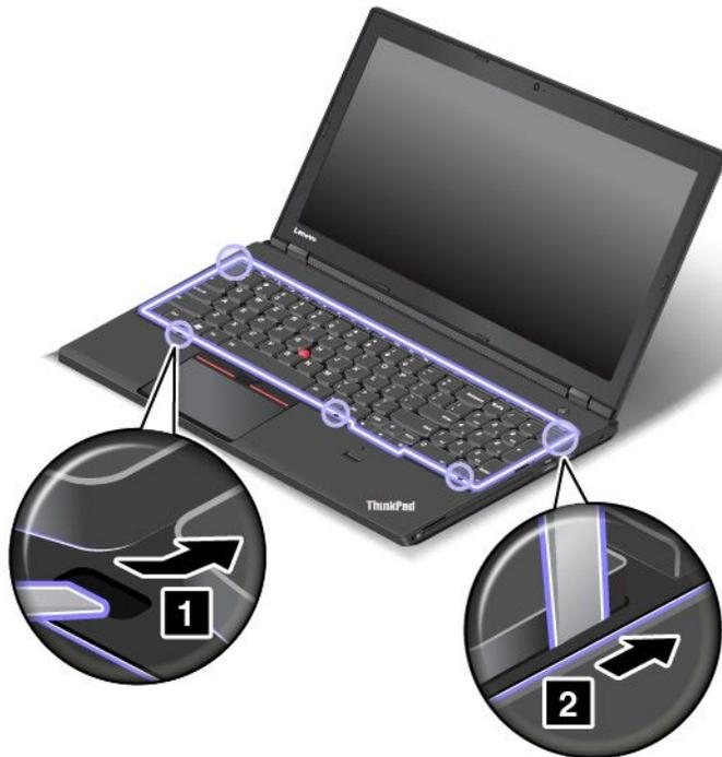
6. Lösen Sie die Schrauben mit der Kreuzschlitzseite des Tastatur-Multifunktionswerkzeuges.
