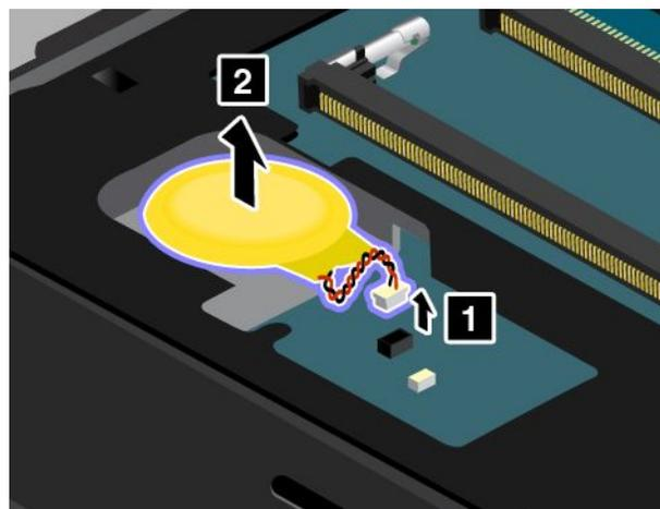
5. Setzen Sie die neue Knopfzellenbatterie **1** ein und schließen Sie dann den Stecker **2** an.
