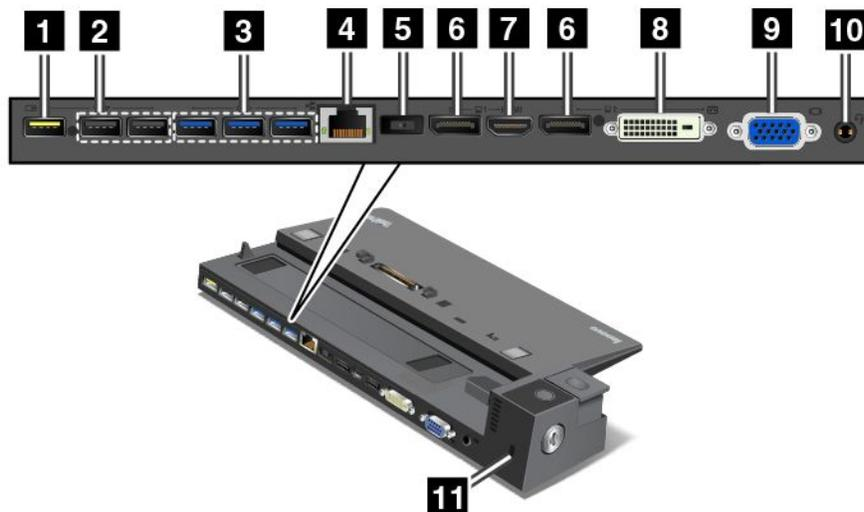
**1 Always-On USB-Anschluss:** Für die Verbindung von Einheiten, die mit USB 2.0 kompatibel sind, oder zum Aufladen einiger digitaler Mobileinheiten und Smartphones, wenn sich der Computer im Energiespar- oder Ruhemodus befindet oder ausgeschaltet ist.
