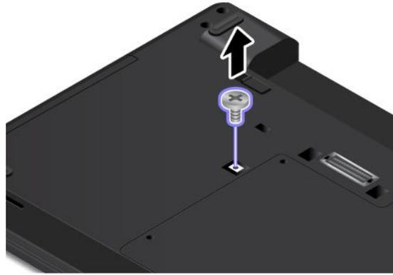
4. Entfernen Sie das optische Laufwerk.
