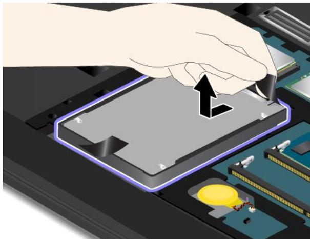
5. Installieren Sie das neue interne Speicherlaufwerk.
