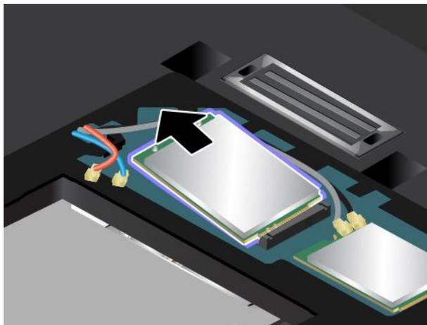
7. Richten Sie die Kante der neuen Karte für drahtlose WAN-Verbindungen mit der Einkerbung an der Aussparung des zugehörigen Steckplatzes aus. Setzen Sie dann die Karte vorsichtig in einem Winkel von ca. 20 Grad in den Steckplatz ein.
