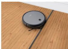
Der Saugroboter ist mit einer Treppenerkennung ausgestattet. Aufgrund von Störfaktoren, wie Sonneneinstrahlung, Bodenbelag/-farbe, Verschmutzungen, etc. kann es in seltenen Fällen zu Irritationen der Sensoren kommen. Um Unfälle und Abstürze zu vermeiden, empfehlen wir daher das optionale Magnetband (nicht im Lieferumfang), welches als Abgrenzung dient.
